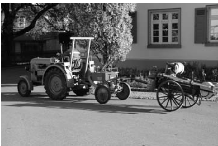
Die alte Zapfwellenspritze aus Dürrenwaldstetten, die von einem Traktor angetrieben werden musste.
