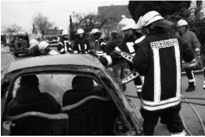
Das Dach am Fahrzeug muss abgeschnitten werden, um den Verletzten bergen zu können.
